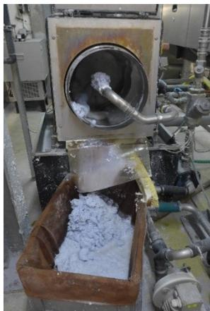
Trommelfilter für die Abwasserreinigung
