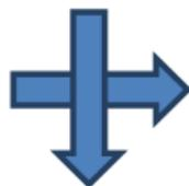
Die Stoffe werden so geführt, dass sich ihre Richtungen kreuzen. Beispiel: Luft-Luft Kreuzstromplattenwärmetauscher in Lüftungs-/Abluftanlagen.
