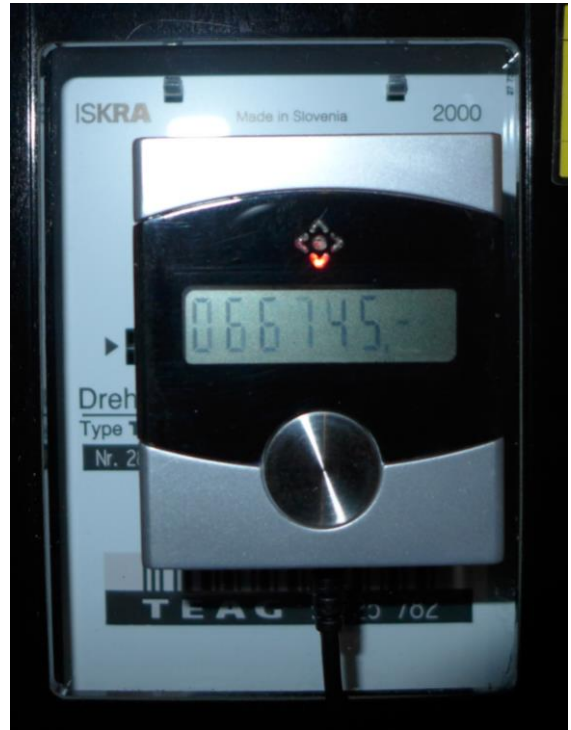
Positionierung der EnergyCam (Verschiebung nach unten nötig) © Handwerkskammer für Ostthüringen
