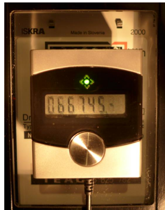
EnergyCam richtig montiert auf einen Ferrariszähler
