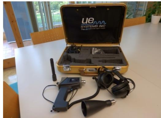
Beispielfoto für ein Ultraschallmessgerät
