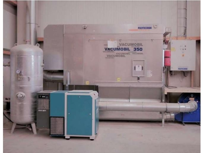
Druckluftanlage (vorne links) und Entstauber.
