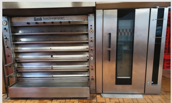
Gärunterbrecher (oben) und Thermoöl-Etagenofen und Stikkenofen (unten) © Handwerkskammer Hamburg
