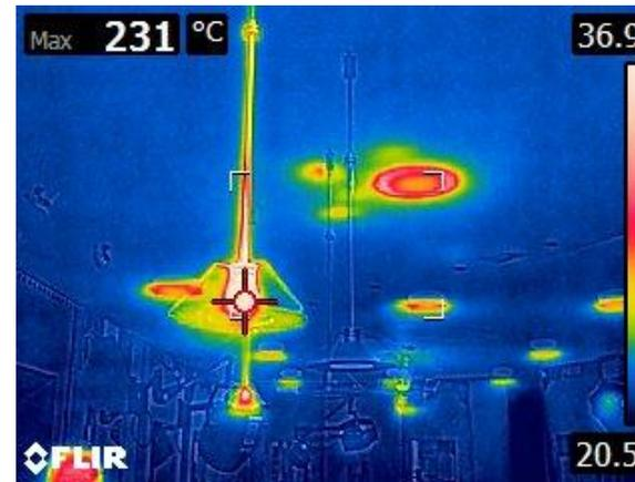
Wärmebild einer Halogenleuchte
