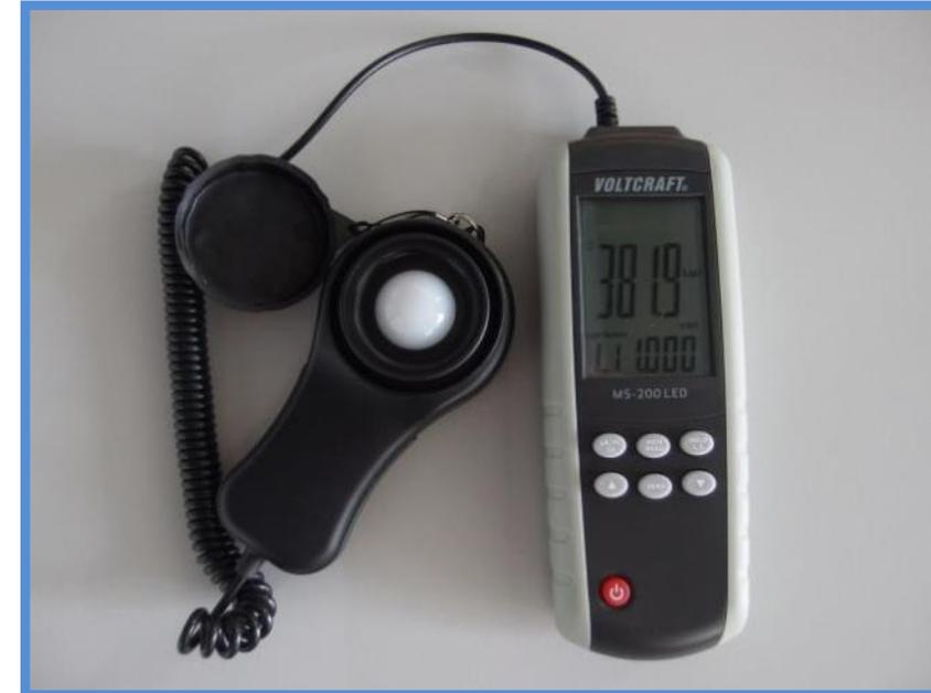
Lux-Meter zur Messung der Beleuchtungsstärke
